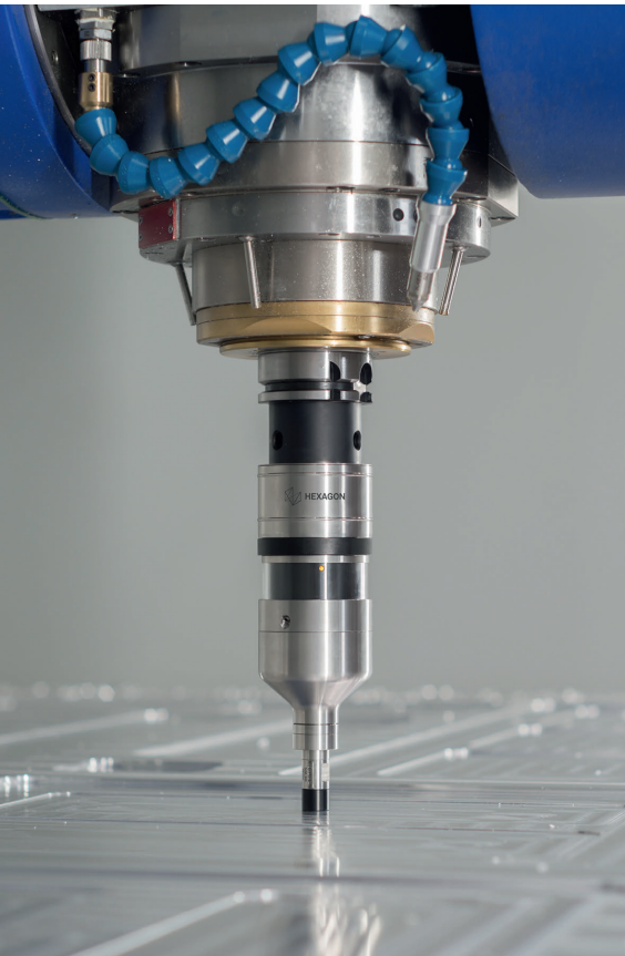
2 Der für die Trockenbearbeitung konzipierte Messkopf RWP20.50-G-UTP-D benötigt kein Kontakt- oder Kopplungsmedium © Hexagon
